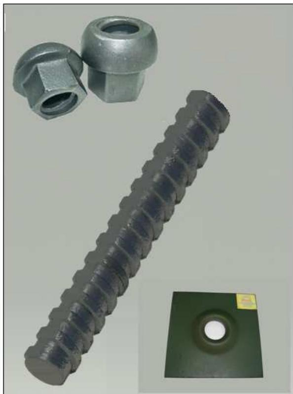
Los pernos helicoidales compuesto por una barra de acero laminado en caliente, de diámetros Ø 19, 22 y 25 mm, con una placa de 4.5 x 200 x 200 mm en calidad A36 y una tuerca de fijación tipo bola, se utilizan como elemento de soporte de alta resistencia en fortificación y el reforzamiento de roca taludes y suelos, manteniendo así la integridad de la roca sometida a esfuerzos de manera que actúan de forma efectiva ya sea como arco o viga tendida a través de la excavación. .
